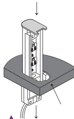
▲ Deslice el multicontacto en el grommet de la cubierta.
