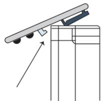
▲ Coloque el gancho de la tapa en el canto frontal superior del multicontacto retráctil.
